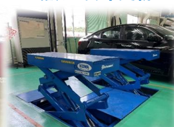
4輪カーリフト更新
